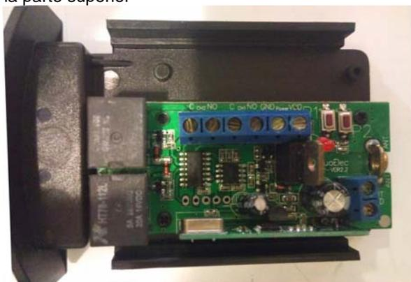
Potencia de salida de los relays: 5 A
